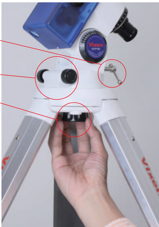
北極星が視認できたら、現在の時刻を確認し、極軸望遠鏡を正確に合わせる。
