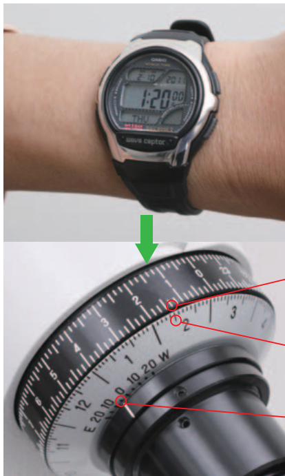
北極星が視認できたら、現在の時刻を確認し、極軸望遠鏡を正確に合わせる。
