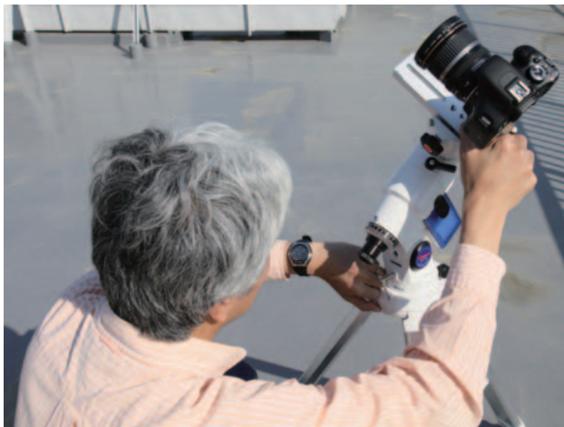
北極星が視認できたら、現在の時刻を確認し、極軸望遠鏡を正確に合わせる。
