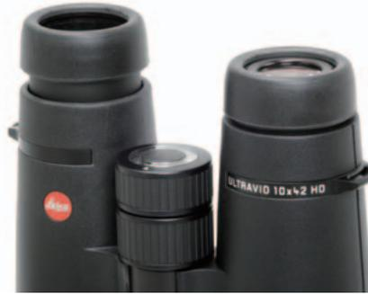
視度補正機構は中央転輪を接眼部側に引き出して行うタイプだが、中央転輪が二連構造で、対物部側が左右同時のピント合わせに、接眼部側が右目の視度補正になっている。両眼のピントと右目の補正が同時にできる秀逸な仕組みだ。見口は無段階のスクリューアップ方式。引き出し量はやや短めでおよそ6mm。
