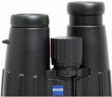
視度補正機構は、中央転輪を接眼部側へ引き出すことで補正目盛の付いたリングが現れ、中央転輪を回すことで右目の視度補正を行う。視度補正時の回転では、0デフォーターのみクリック感がある。見口はクリック付きで4段階のスクリューアップ方式。引き出し量はやや長めで12mmほどだ。
