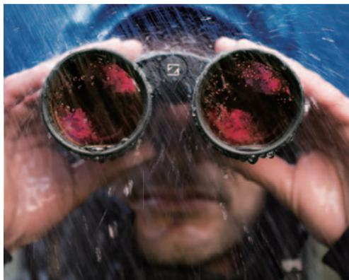
高級機の証である性能に、防水性能や耐寒性能がある。天体観望では、雨中での使用はあり得ないが、夜露で水滴が付くことは誰もが経験しているはず。高級機では防水構造にした上で、鏡体内部に乾燥窒素ガスを充填し、温度が変化してもレンズの内部が曇らないようにしている。また、極寒の環境下でもピント合わせなどの可動部にトラブルが起きないように、潤滑油にも配慮がされている(写真はカールツァイスのカatalogより)。
