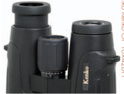
視度補正機構は、中央転輪を接眼部側へ引き出すことで補正目盛の付いたリングが現れ、中央転輪を回すことで右目の視度補正を行うことが可能。視度補正時のリングの回転には軽いクリック感がある。見口はクリック感のないスクリューアップ方式、引き出し量はかなり長めで約15mmもある。
