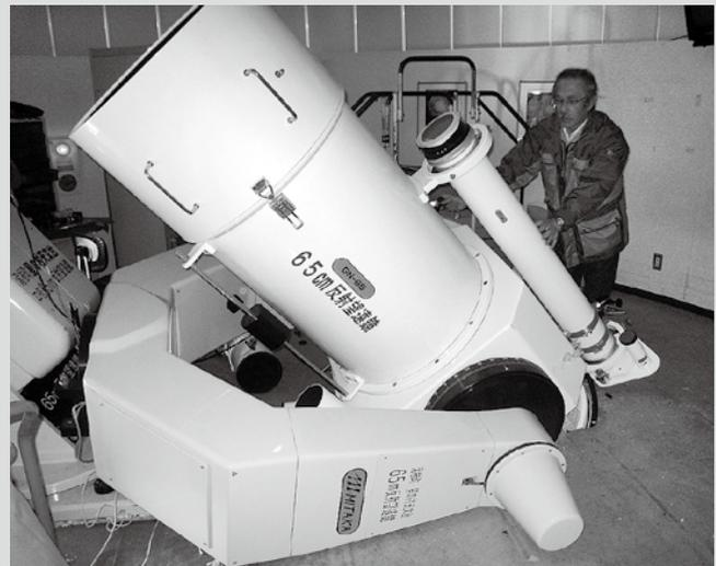
極軸の折れた65cm反射望遠鏡(福島県田村市 星の村天文台 大野裕明氏撮影)。
