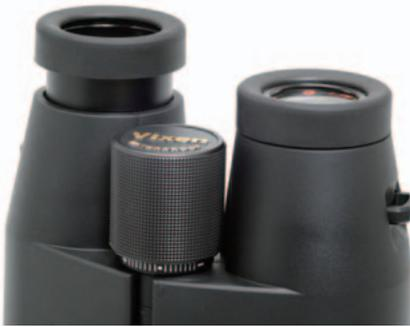
見口はクリック感のないスクリューアップ式で、引き出し量は10mmほど。視度補正は、中央転輪を接眼部側に引き出すと目盛が現れ、そのまま中央転輪を回すことで右目側の視度を補正する。補正時の回転はクリック感がある。
