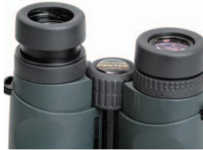
視度補正機構は、右側接眼部の見口の付け根に補正用リングがある。リングを接眼部側に引き上げてロックを解除し、回転させることで視度補正を行う。見口はクリック付きのスクリューアップ方式で、4段階の調整が可能。引き出し量は約8mmだ。
