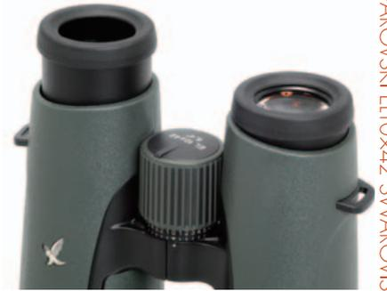
接眼見口はクリック付きの3段階スクリューアップ方式で、引き出し量は約12mm。左右の視度補正機構は、中央転輪を接眼部側へ引き出して合わせるタイプ。補正目盛の付いたリングが現れ、中央転輪を回すことで右目の視度補正を行う。視度補正時の中央転輪の回転にはクリック感があり、小刻みに調整できる。
