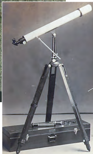
▶1929年に発売された、アクロマート対物レンズ採用の高性能望遠鏡「ウラノス号」。
