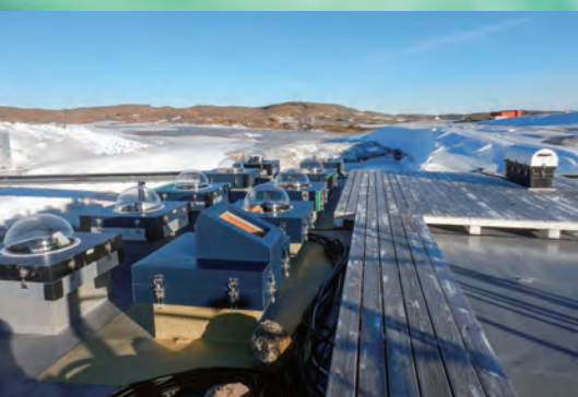
昭和基地では長期にわたってさまざまな機器でオーロラの観測を続けている。写真は2018年時の光学観測用のカメラ。(撮影/西山尚典(国立極地研究所))
