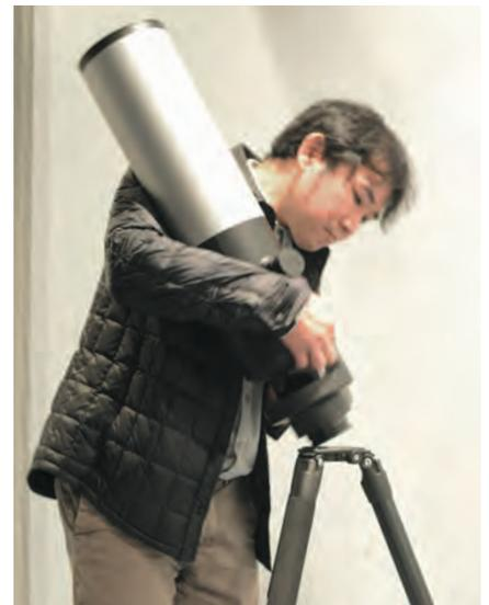
eVscopeの組み立ては三脚に本体を載せ、2本の押さえネジを締めるだけで完了。鏡筒を持ち運ぶ専用リュックサックも用意されています。
