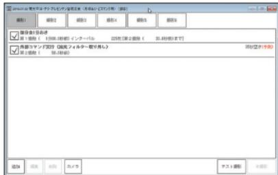
以下は、第3接触30秒後に減光フィルターを取り付ける場合の「外部コマンド実行」ダイアログの設定です。
