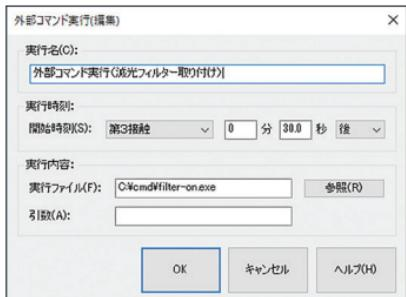
撮影設定が正しければ「部分食→外部コマンド実行（減光フィルター取り外し）→ダイヤモンドリング→コロナ→ダイヤモンドリング→外部コマンド実行（減光フィルター取り付け）」の順になります。
