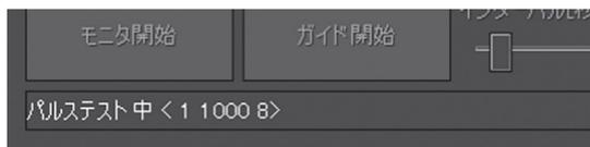
望遠鏡ステータス：望遠鏡の姿勢やパルス反転の状態が表示されます。正しくガイドができない場合は、ステータス表示と望遠鏡の実際の姿勢が正しく一致しているかなどを確認してください。
