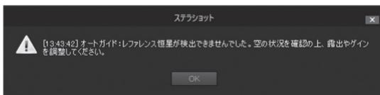
**A:** リアルタイム画面に恒星が10個前後しっかりと映るように「ゲイン」「露出」を調節します。併せてガイド鏡のピントをしっかりと合わせます。
