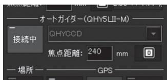
○リアルタイム画面に映るガイド星が4つ以上になるように、感度と露出を上げる。「ゲイン」を100%、「露出[秒]」を1～2秒に設定する・ノイズが多い場合はガイド鏡に蓋を被せて[ダーク取得]を行う
