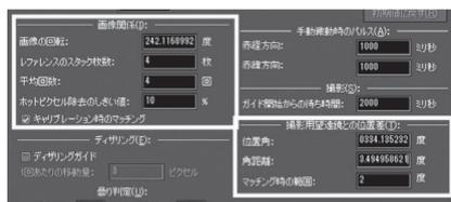
キャリブレーションの結果はステラショットに保存されますので、撮影機器や望遠鏡を変えない限り、次からはキャリブレーションなしでオートガイドが行えます。また、複数のキャリブレーション結果を保存／読み込みができますので、観測機器の組み合わせごとにキャリブレーションをしておき、ワンタッチで切り替えることもできます。
