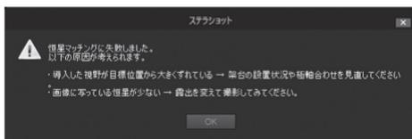
**A:** マッチングを行うよう設定した状態で、リアルタイム画面に映っている恒星が少なく、望遠鏡が向いている方向の星図とマッチングできない場合に表示されます。警告の場合には無視してもかまいません。ただしガイド精度は落ちるので、対処として、ガイド星の数やオートガイド設定等を次の通り確認します。
