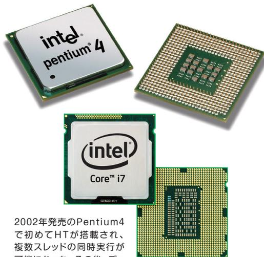
2002年発売のPentium 4で初めてHTが搭載され、複数スレッドの同時実行が可能になった。その後、デュアルコアのPentium DからIntel Coreシリーズへ、そして現在のCore iシリーズへとつながる。マルチコアCPUとマルチコア対応ソフトを連携して使うことが前提の時代になっているのだ。
