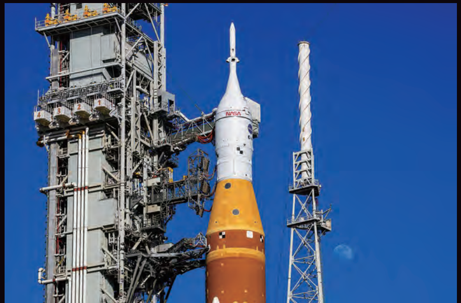
アルテミスII実施に向けてSLS ロケットに搭載されたオリオン宇宙船。©NASA/Sam Lott
