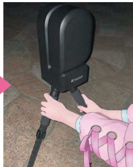
付属の三脚を広げて大まかに水平を調整し、Seestar S50 本体を載せます。これでセット完了です!
