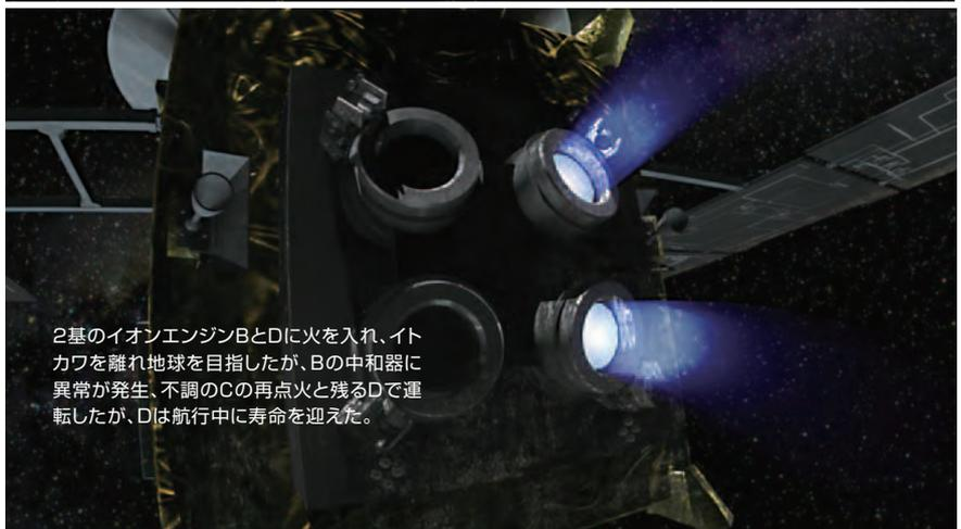
2基のイオンエンジンBとDに火を入れ、イトカワを離れ地球を目指したが、Bの中和器に異常が発生、不調のCの再点火と残るDで運転したが、Dは航行中に寿命を迎えた。
