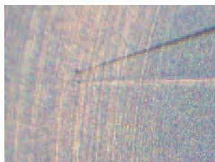
サンプルコンテナの開封や微小粒子の確認作業は、キュレーションセンターで慎重に行われている。画像上の光る筋がマニピュレータ、先端の黒っぽい粒が微小粒子である。黒い筋はマニピュレータの影。
