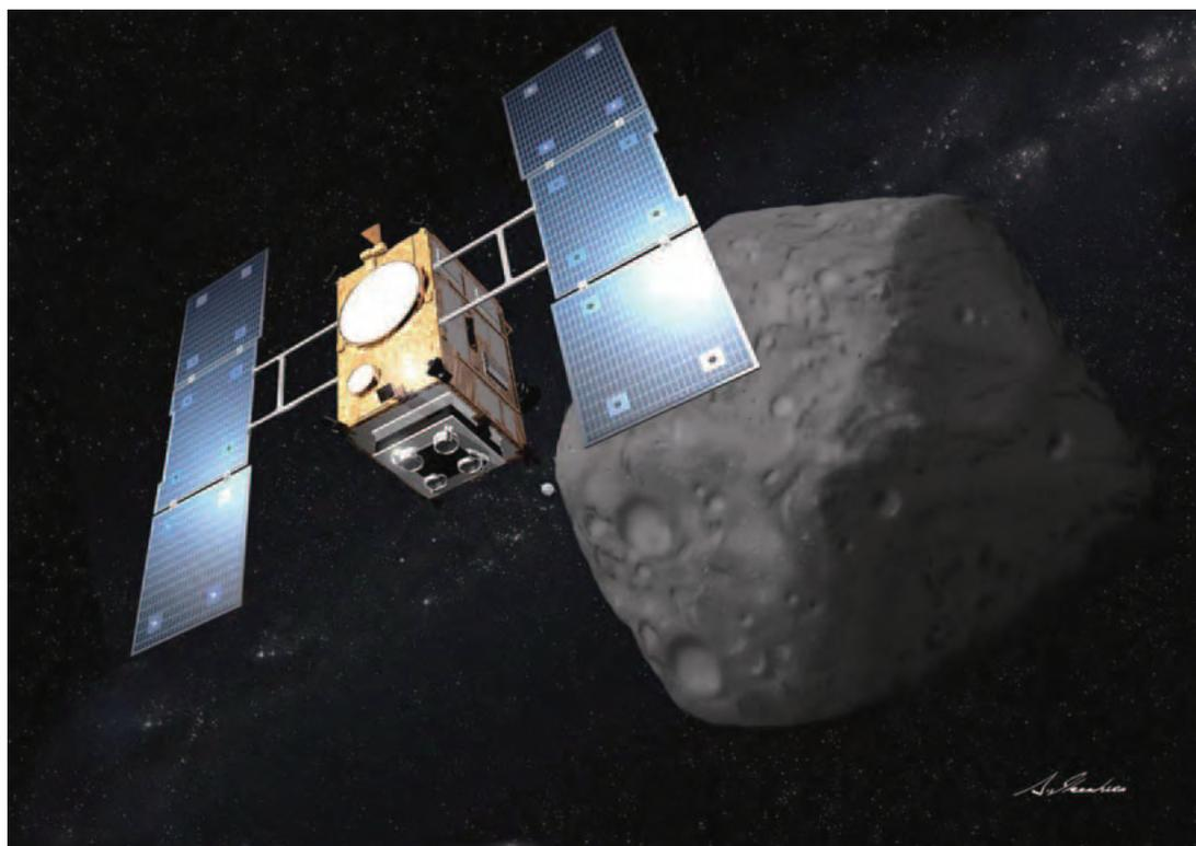
「はやぶさ2」は、「はやぶさ」と同じように、イオンエンジンと地球スウィングバイを組み合わせる目的の小惑星まで航行する。「はやぶさ2」の機体の基本構造は「はやぶさ」と同じだが、いくつか変更する点もある。まず、C型小惑星の表面のようすは、「はやぶさ」が探査したS型小惑星とは異なっていると予想されるので、分光観測や試料採取の装置をC型小惑星に適したものに改良する。また、「はやぶさ」初号機の運用で問題が発生したリアクションホイールや化学スラスタなどに改良を施し、平面アンテナを用いるなど、「はやぶさ」以降に進化した技術も導入している。
